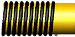
**PASO 2** : Y finalmente realizaremos una diferencia de sólidos, restando al cilindro el muelle, para ello utilizaremos la orden que encontraremos en el menú: *Modificar / Editar sólidos / Diferencia* obteniendo de esta forma el resultado que podemos apreciar en la imagen.
