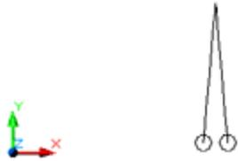
**PASO 6** : A continuación extruiremos dichos círculos, mediante el comando EXTRUSIÓN, utilizando los semicírculos, como Ejes de extrusión. Seguidamente unimos las dos piezas, mediante el comando UNIÓN, que encontraremos en el menú:
