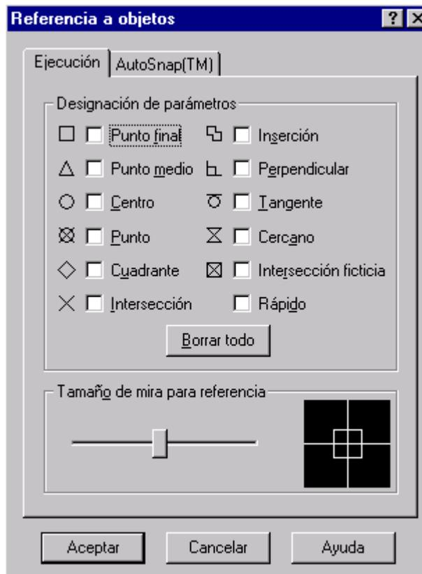
La referencia a objetos es una forma rápida de emplazar con exactitud un punto en un objeto sin tener que conocer sus coordenadas ni dibujar líneas auxiliares. Con la referencia a objetos puede dibujar una línea que acabe en el centro de un círculo, el punto medio de un segmento de polilínea o en una intersección imaginaria.
